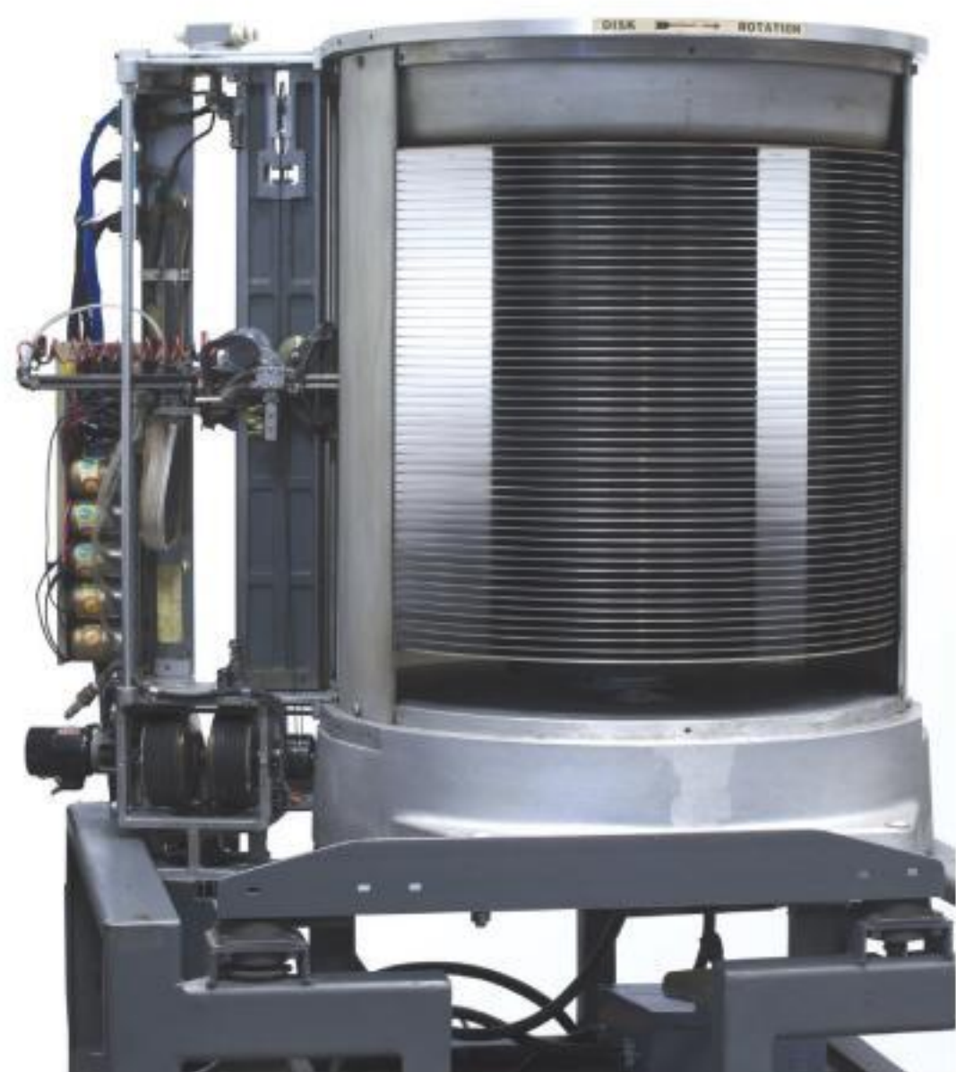
Пятьдесят магнитных дисков и механизмы считывающих головок IBM Model 350 точно бы не поместились в корпус микрокомпьютера. Впрочем, ему это было и незачем — персонал еще не существовало.
